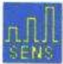
Il tasto Sensibilità serve a stabilire quanto è alta una oscillazione nel tracciato dando per parametro standard che  $1 \text{ mV} = 10 \text{ mm}$
